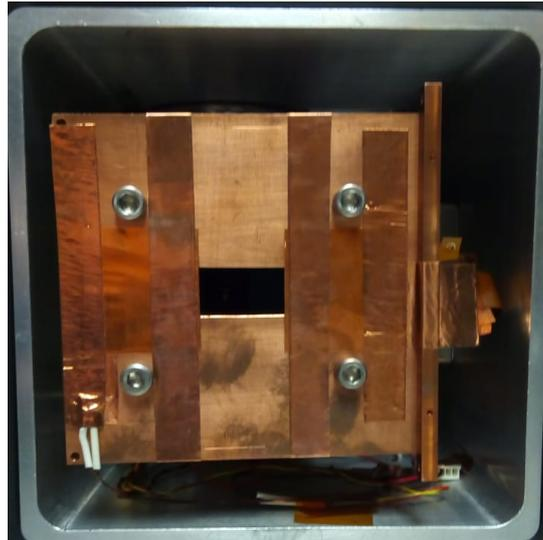
Figura 4.5: Vista frontal del CCD. Se colocaron laminas de cobre a ambos lados del detector para evitar que los rayos X de la fuente de  $^{55}\text{Fe}$  sigan impactando en el silicio una vez terminado el tiempo de exposición
