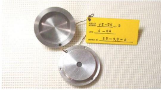
Figura 4.1: Imagen de la fuente de  $^{55}\text{Fe}$  utilizada.
