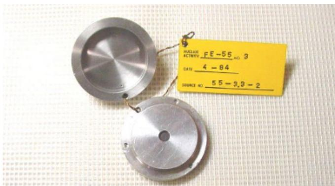
**Figura 19:** Muestra de  $^{55}\text{Fe}$  utilizada para las mediciones.
